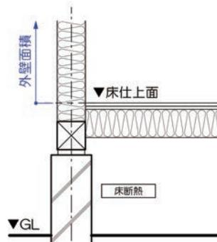
図 2.2.2.9 床断熱住戸の外壁面積
